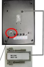
Die Ethernet-Schnittstelle an der Rückseite des KM2 wird zu diesem Zeitpunkt nicht verwendet. Eine neue 801390 BOH Adapter mit Ihrem neuen KM2 ausgeliefert. Bitte ersetzen Sie Ihren alten 801.114 BOH-Adapter mit dieser neuen vorgesehen. COM1-COM4 und Power Ports sind dieselben wie auf dem KM1, COM1-verwendet.
