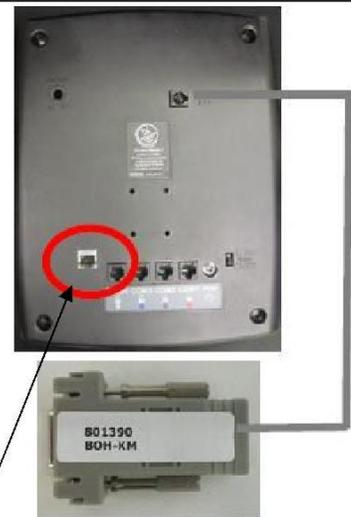
KM2의 뒷면에 있는 이더넷 포트는 이 때 사용할 수 없습니다. 새로운 801390 BOH 어댑터는 새로운 KM2와 함께 배송됩니다. 제공된 새 제품으로 기존 801114 BOH 어댑터를 교체하십시오. COM1-COM4 및 전원 포트는 KM1, COM1-COM3 = PHU# 1-9과 동일하게 사용됩니다.
