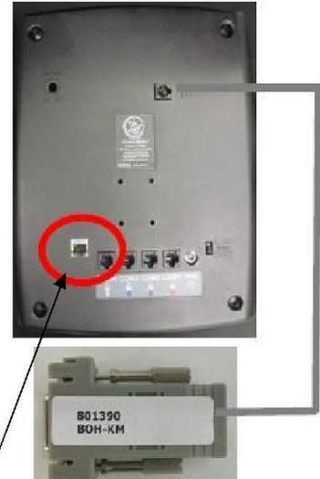
El puerto Ethernet en la parte posterior de la KM2 no se utiliza en este momento. Un nuevo adaptador 801390 BOH se ha enviado con su nueva KM2, reemplace el adaptador 801114 BOH edad con esta nueva que se proporciona. COM1-COM4 y Puertos de alimentación se utilizan igual que en el KM1, COM1-COM3 = PHU# 1-9, COM4 = Signo de Grado Potencia=KM1 Fuente de alimentación 12VDC, 1.25A
